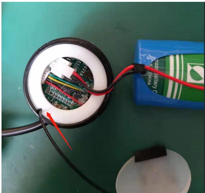
图 3. 白色套圈卡入传感器
