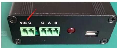
电源输入支持 9V 到 24V 直流输入。电流需要大于 500mA。二个电源接口不能同时接入，只需选择一路接口供电即可。
