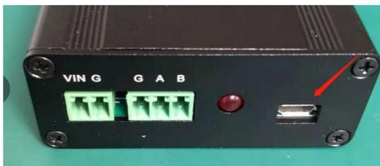
建议先上电之后再插入 usb 接口。如果没有上电之前插入 usb 接口，则设备会从 usb 取电。
