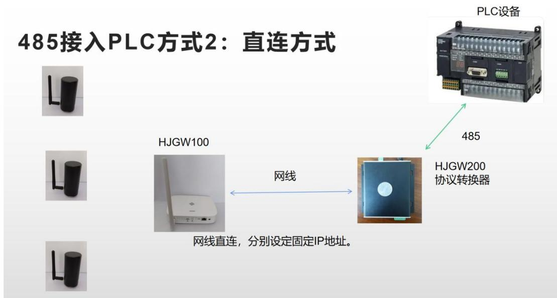
注：MODBUSTCP 协议以及 485 MODBUSRTU 协议请参考 HJGW200 网关规格书
